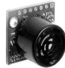
Fig. 1(b). Maxsonar-EZ2 Sensor
