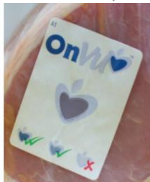
Kemasan aktif antimikroba dalam bentuk chip
