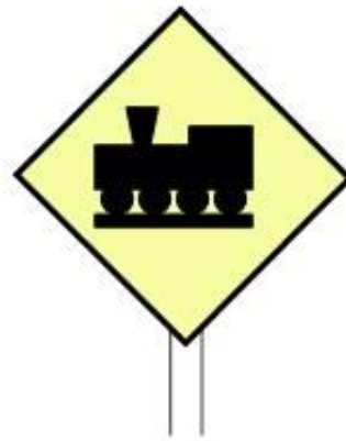
RAMBU NO 24 PERLINTASAN SEBIDANG JALAN REL DENGAN JALAN RAYA BERPINTU
