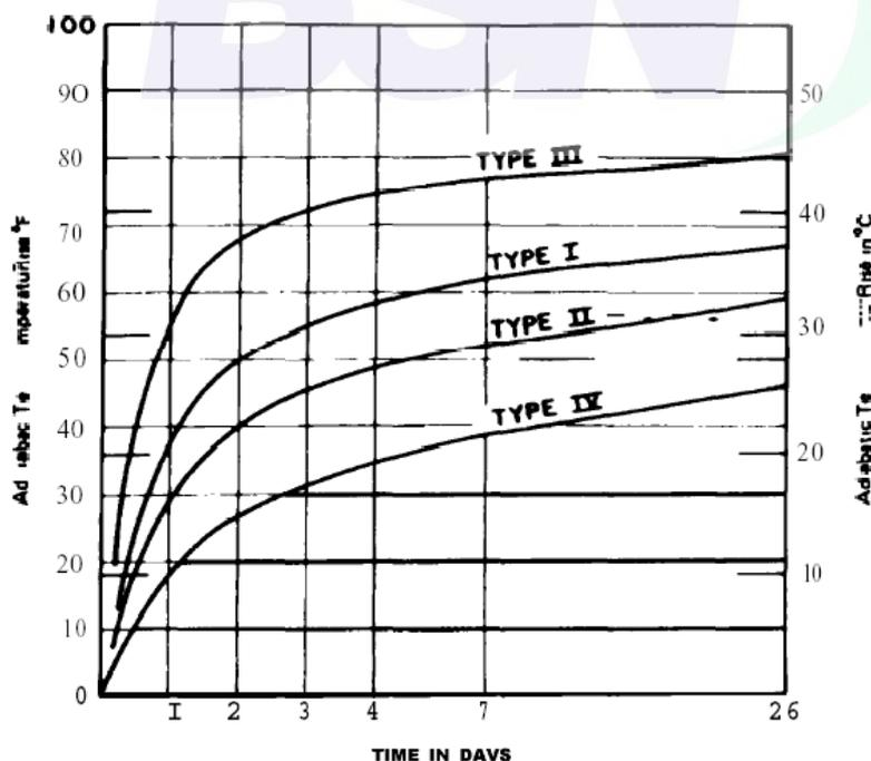
Gambar A.1 - Grafik temperatur beton massa yang mengandung 223 kg/cm<sup>3</sup> semen
