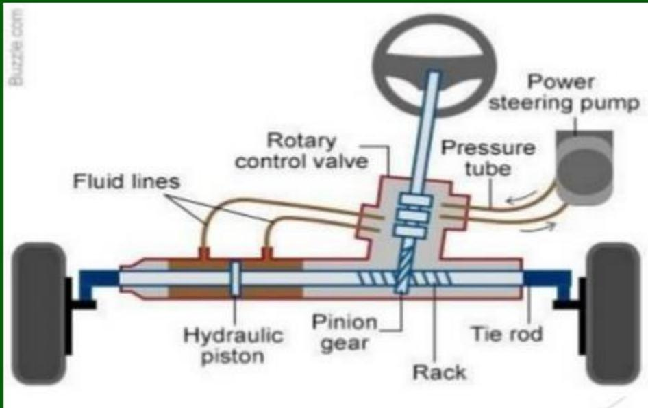
Ketika pinion berputar, rack akan bergerak lurus. Mekanisme ini digunakan pada beberapa jenis kendaraan untuk mengubah rotasi dari setir kendaraan menjadi pergerakan ke kanan dan ke kiri dari rack sehingga roda berubah arah.
