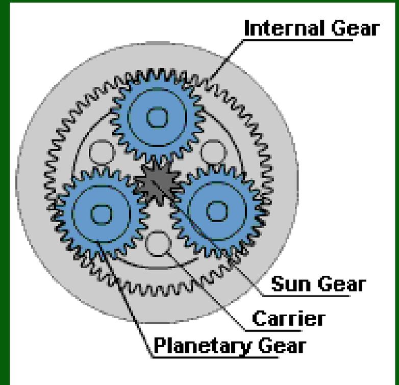
**Roda gigi** secara umum merupakan suatu mekanisme yang dipergunakan untuk memindahkan elemen mesin yang satu kegerakan elemen mesin yang lain.
