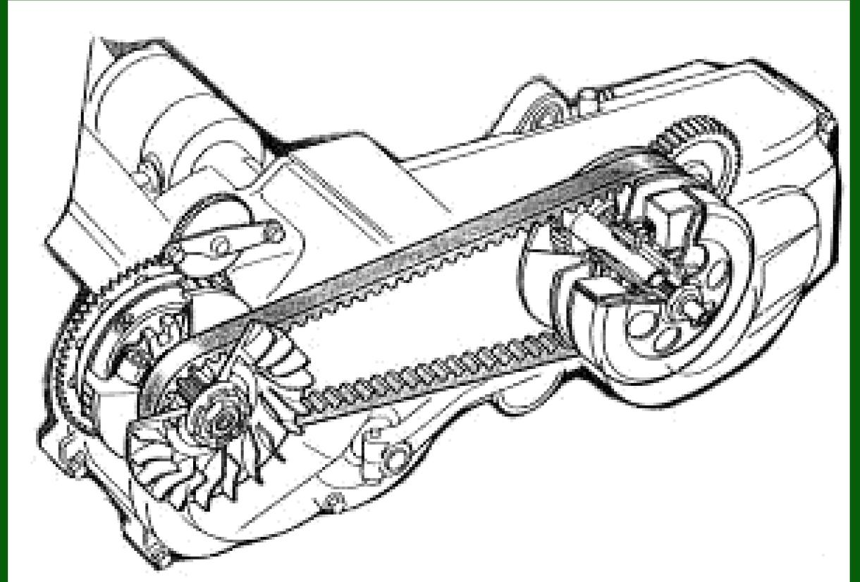
Transmisi sabuk-puli (belt and pulley) ... Sabuk-V terbuat dari **karet** dan mempunyai penampang trapesium. ... jarak poros menengah (antara belt dan **gear**).
