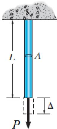
Gaya  $P$  yang bekerja pada sebuah Bar seperti yang terlihat pada Gambar, dikonversikan menjadi *strain energy* yang menyebabkan pertambahan panjang pada batang sebesar  $\Delta$  dan timbulnya tegangan  $\sigma$ . Mengingat Hukum Hooke :  $\sigma = E\epsilon$ .
